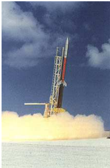
Abbildung 1.3: Frühe Röntgenastronomieexperimente: Zweistufige Nike-Tomahawk Rakete, die den Röntgendetektor für einige Minuten außerhalb der Erdatmosphäre brachte (links); Höhenballon für Höhen um 50 km und einer Beobachtungszeit von 10 Stunden mit Röntgen- und Gammastrahlendetektor (Energiebereich: 15 - 120 keV) (rechts)
