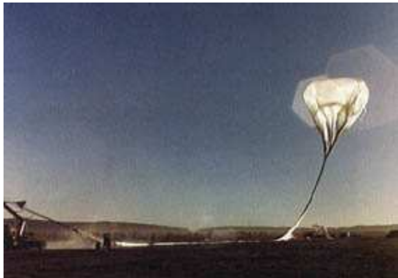
Abbildung 1.3: Frühe Röntgenastronomieexperimente: Zweistufige Nike-Tomahawk Rakete, die den Röntgendetektor für einige Minuten außerhalb der Erdatmosphäre brachte (links); Höhenballon für Höhen um 50 km und einer Beobachtungszeit von 10 Stunden mit Röntgen- und Gammastrahlendetektor (Energiebereich: 15 - 120 keV) (rechts)
