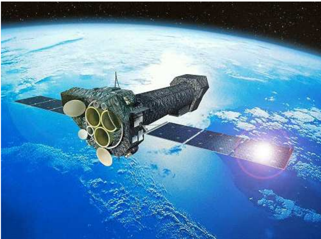
Abbildung 1.10: Europäischer Röntgensatellit XMM-Newton, deutlich sind die drei 7,5 m langen Röntgenteleskope und die Schutzverkleidungen erkennbar
