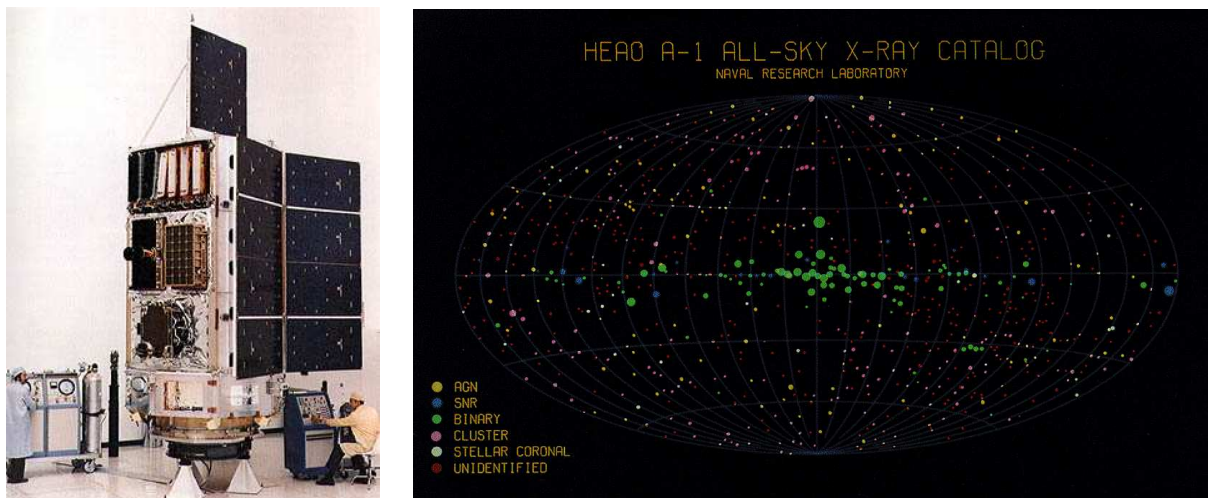
Abbildung 1.6: Röntgensatellit HEAO-1, deutlich sind die 400 Watt erzeugenden Solarpanels und die Experimenteneinheit erkennbar (links); HEAO-1's multispektrale Röntgendurchmusterung, die Größe der Punkte bezeichnet die Helligkeit der Quelle (rechts)
